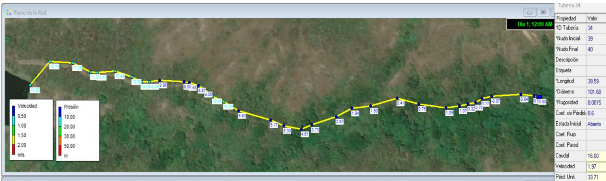
Figura 40. Diagrama de velocidades, 16 LPS
